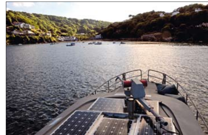
Panneaux photovoltaïques Placés à plat sur le toit du rouf, neuf panneaux photovoltaïques couvrent une surface de 10 m 2 .
