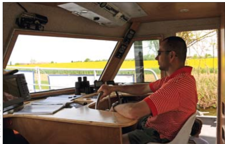
Eric est à la barre, située à l'avant tribord du bateau. Les huisseries sont en contreplaqué labellisé PEFC.
