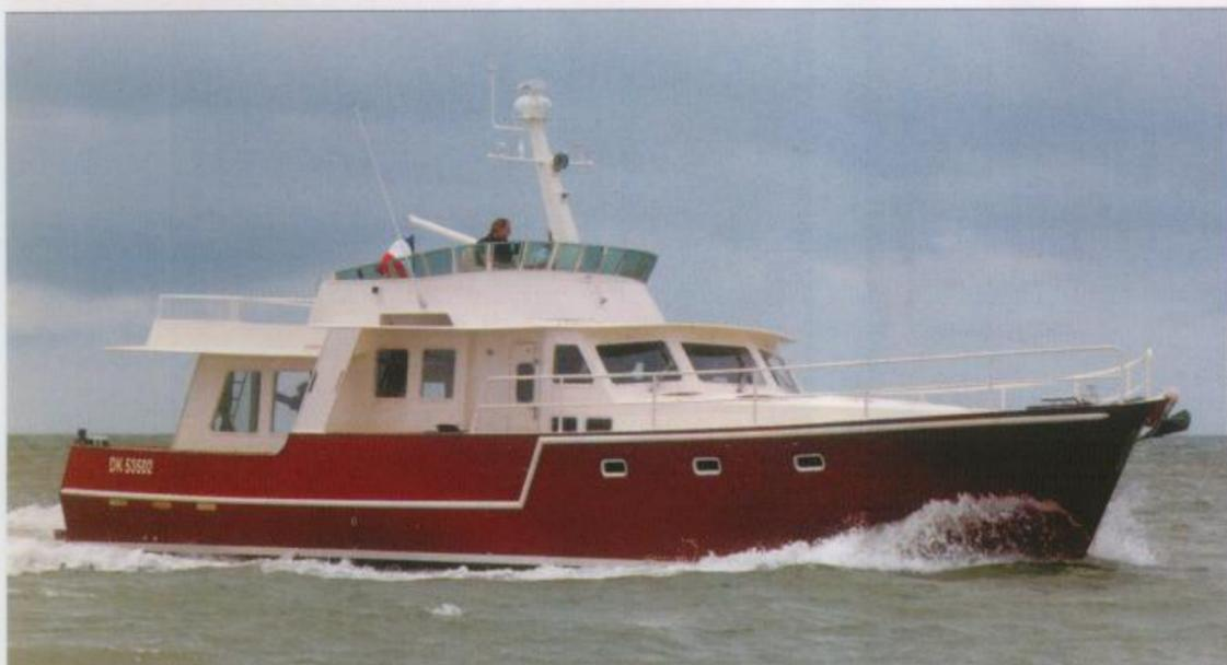
Sous le fly, les passavants permettent d'aller en toute sécurité du cockpit au poste de barre intérieure, protégé par deux portes étanches.
