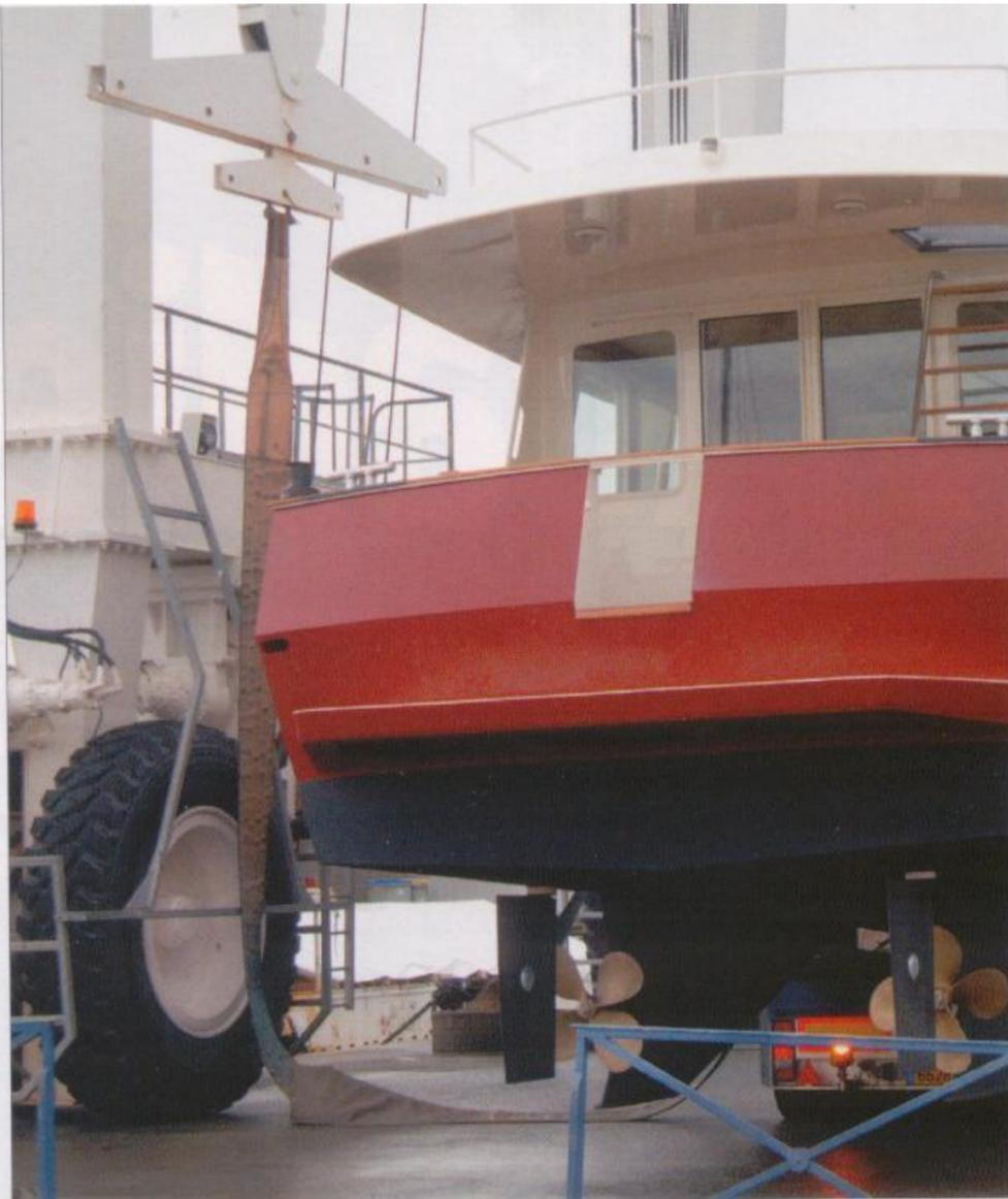
Deux robustes ailerons protègent efficacement les safrans et les hélices du bateau à l'échouage et en navigation lors de la rencontre d'objets flottants non identifiés.
