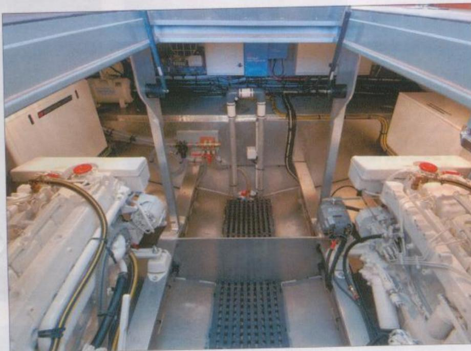
Vaste et claire, la salle des machines permet des interventions faciles sur les deux Nanni 165 ch et sur le groupe électrogène Northern Lights. Bien isolée, elle génère un niveau sonore très acceptable dans le carré.
