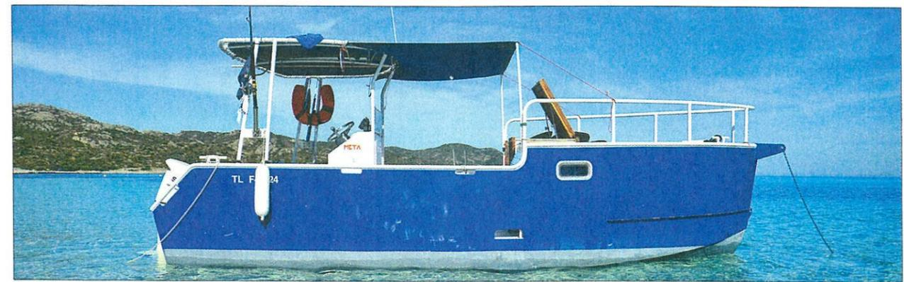
Étrave droite, coque en Strongall, pont avant surélevé, console centrale de pilotage reculée pour permettre de placer une table devant, *Petitboat* est un bateau unique.
