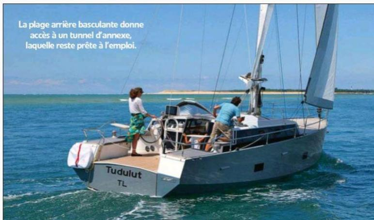
La plage arrière basculante donne accès à un tunnel d'annexe, laquelle reste prête à l'emploi.
